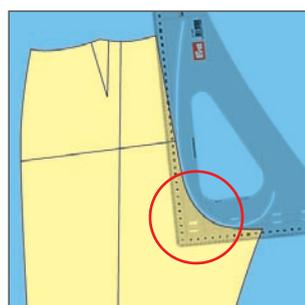
Выштампованный на портновском лекале треугольник имеет три разных скругленных угла, благодаря которым легко и удобно вычерчивать клапаны карманов, лацканы, воротники и многие другие узкие скругленные участки.
