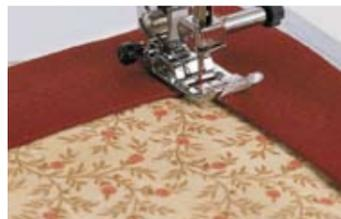
Не требуется поворачивать маховик, чтобы опустить иглу. При обработке углов выберите «останов иглы в нижнем положении» и поверните ткань соответственно, при обработке прямых швов выберите «останов иглы в верхнем положении».
