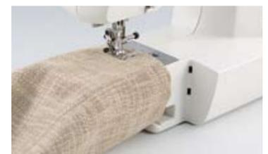
Съемная панель позволяет плоскую платформу машины преобразовать в цилиндрическую, что очень удобно при обработке цилиндрических деталей: рукавов, штанин, а также для пришивания карманов.
