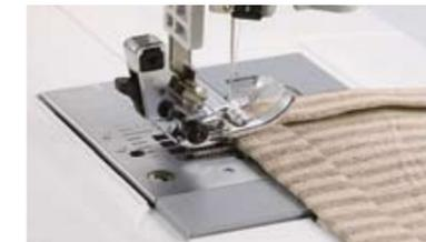
Обеспечивает необходимое положение лапки для обработки деталей изделия с изменяемой толщиной, например, в начале шва или при пересечении швов.
