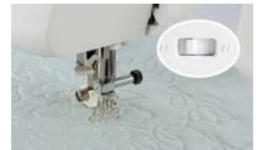
Рычаг опускания рейки используется для свободной подачи ткани при стегании, вышивке и выстрачивании монограмм.
