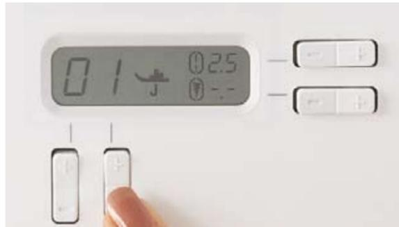
На жидкокристаллическом дисплее отражаются данные по длине стежка, ширине строчки и типу прижимной лапки для выбранной строчки.
