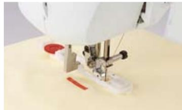
Механизм выметывания петель в один прием с автоустановкой размера позволяет создавать абсолютно одинаковые петли. Просто выберите функцию выметывания петель и следите за направлением шитья всех 4-х сторон петли без поворота рычага.
