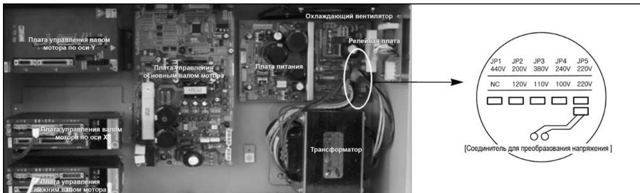
[Переключающий соединитель для настройки напряжения электропитания]
